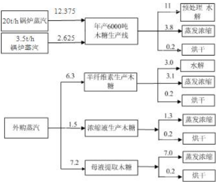
图 2 全厂蒸汽平衡图（单位 t/t）
